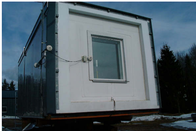
Kuva 10. Tuloilmaikkuna asennettuna PASLINK-testitilan julkisivuun.
